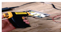
(3)插入電源，使變壓器逐漸升溫，使用紅外線測溫槍，測量每5分鐘變壓器的內、外部溫度變化
