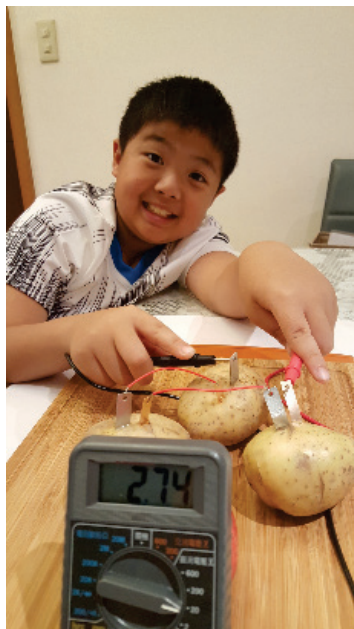
串連三個馬鈴薯-LED 燈亮 3 個馬鈴薯電力 2.74V
