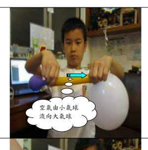
04. 用左手輔助施力,先施力於左端大 氣球,嘗試將空氣擠壓到小氣球 內,觀察且體會施力結果。
